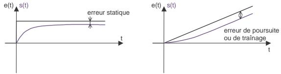
avec e(t) et s(t) de même nature. Autrement, l'erreur est mesurée en sortie du comparateur.
