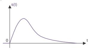
Cas 2 : Z=1, amortissement critique. La sortie dans le domaine de Laplace s'écrit :  $S(p) = \frac{K\omega_0^2}{(p+\omega_0^2)^2}$
