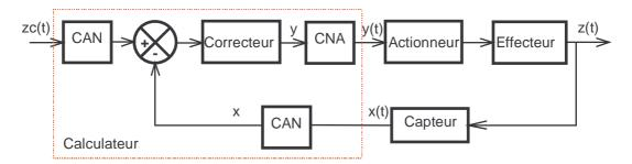
Des convertisseurs Analogique - Numérique transforment en nombres les grandeurs d'entrée et mesurée à un instant donné. Les informations sont, ensuite, traitées. Puis, un convertisseur Numérique – Analogique transforme l'ordre pour qu'il puisse être interpréter par l'actionneur. Ces opérations sont exécutées à une certaine fréquence.
