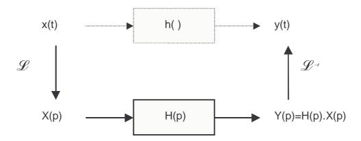
Le calcul de la transformée de Laplace inverse de Y(p) nécessite une décomposition en éléments simples dont les transformées inverses sont connues.
