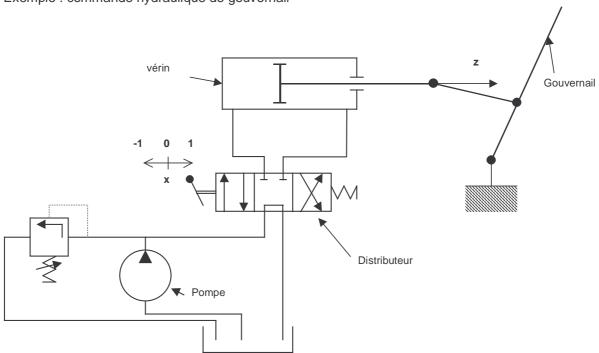
Dans cet exemple, la position du distributeur au cours du temps détermine le sens de déplacement de la tige du vérin.
